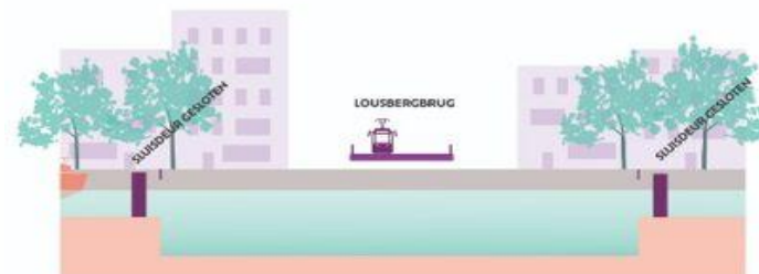
0 Standaardsituatie, beide sluisdeuren zijn gesloten.
