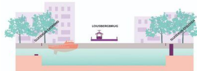
1 In de valsluis varen de schepen binnen, waarna de deuren worden gesloten.
