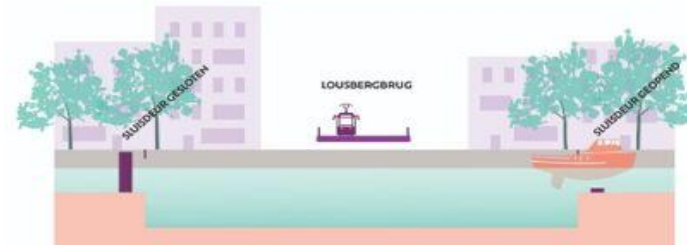
3 Daar wachten ze tot de sluis zich weer helemaal met water gevuld heeft en het oorspronkelijke waterniveau is bereikt. Vervolgens openen de sluisdeuren zich en kan het schip haar weg vervolgen.
